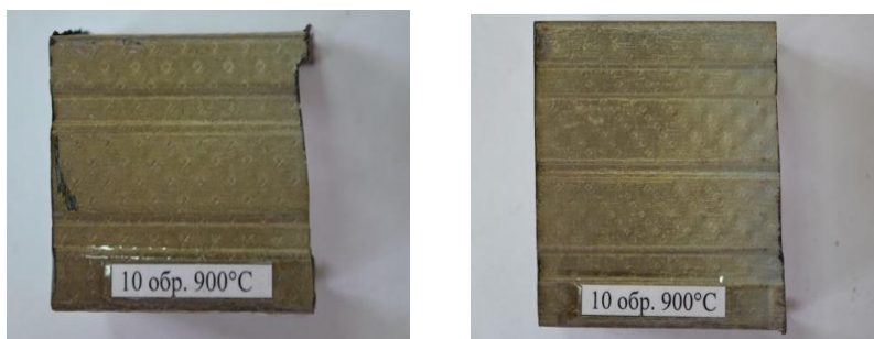
Рис. 7. Профиль стоечный (а) и профиль направляющий (б) при температуре 900 0 С
