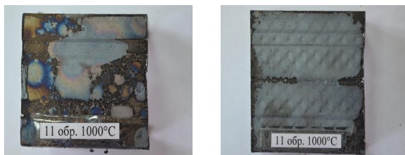
Рис. 8. Профиль стоечный (а) и профиль направляющий (б) при температуре 1000 0 С
